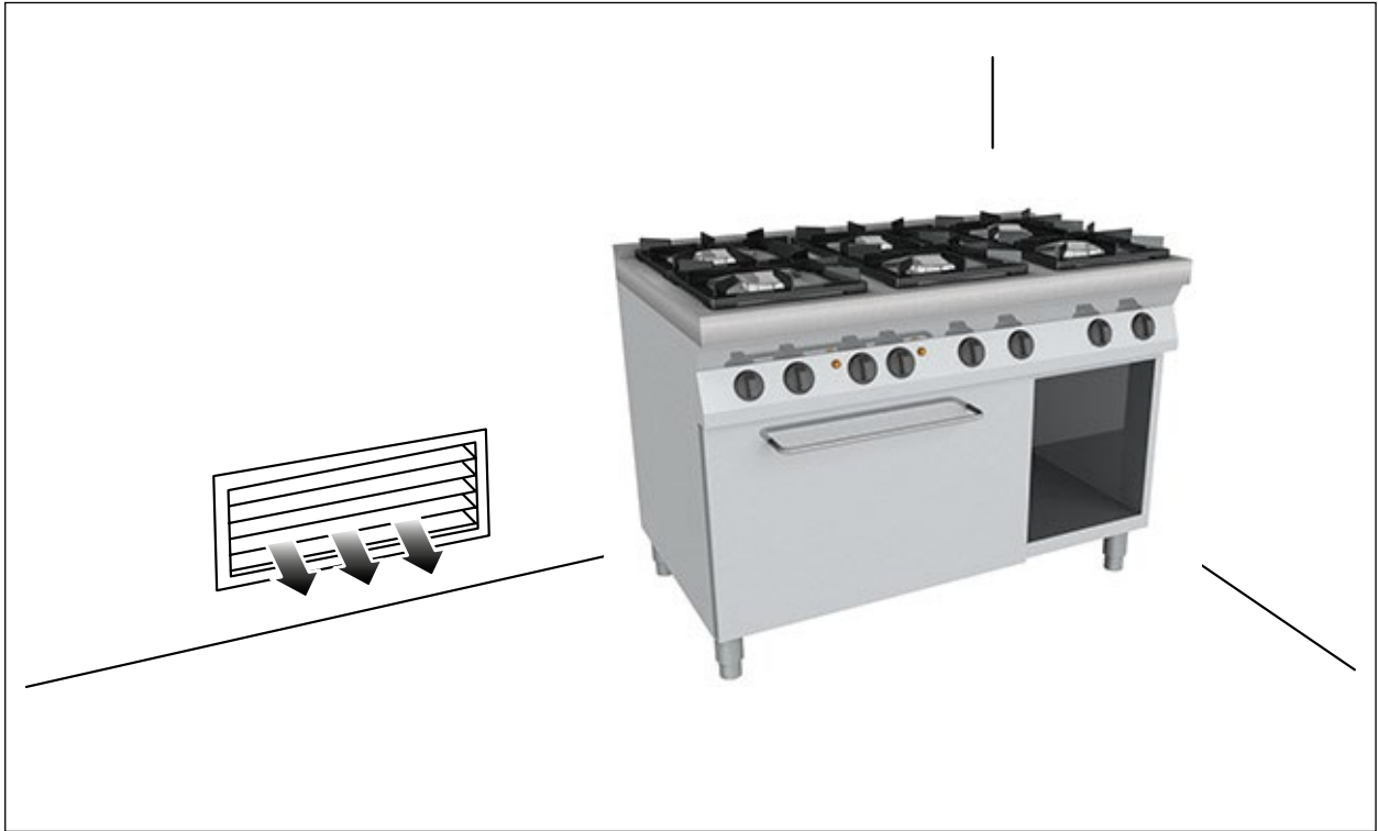
Fig. 13 Ventilazione del locale di installazione
